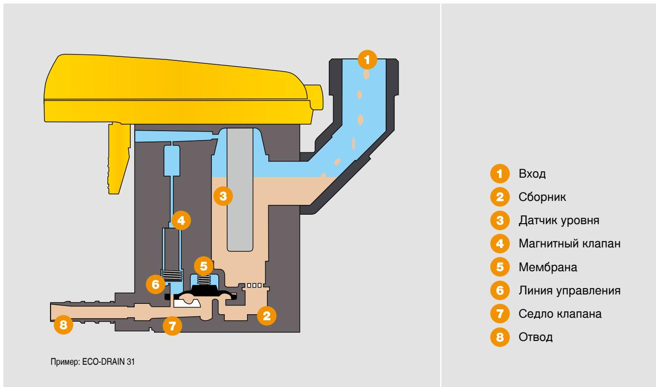
Конденсат поступает через **вход** (1) в **сборник** (2). **Датчик уровня** (3) контролирует уровень наполнения емкости и передает сигнал электронному управлению, которое открывает **электромагнитный клапан** (4) и **линию управления** (6). В результате выравнивания давлений происходит открытие
