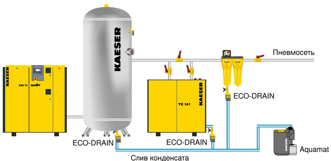
Во всех местах пневмосистемы, где происходит сбор конденсата, должен обеспечиваться надежный отвод. Наилучшим образом решает эту задачу электронное устройство отвода конденсата.
