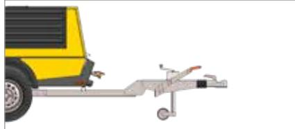
Нерегулируемое дышло с инерционным тормозом наката и стояночным тормозом
