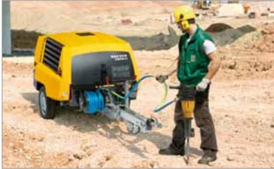
Устанавливаемый на заводе барабан рассчитан для 20 метров шланга, который для работы нет необходимости полностью разматывать. Правильное хранение повышает надежность и увеличивает срок службы шланга, а также предохраняет его от повреждений (перегибов, деформации, наездов) и загрязнения.
