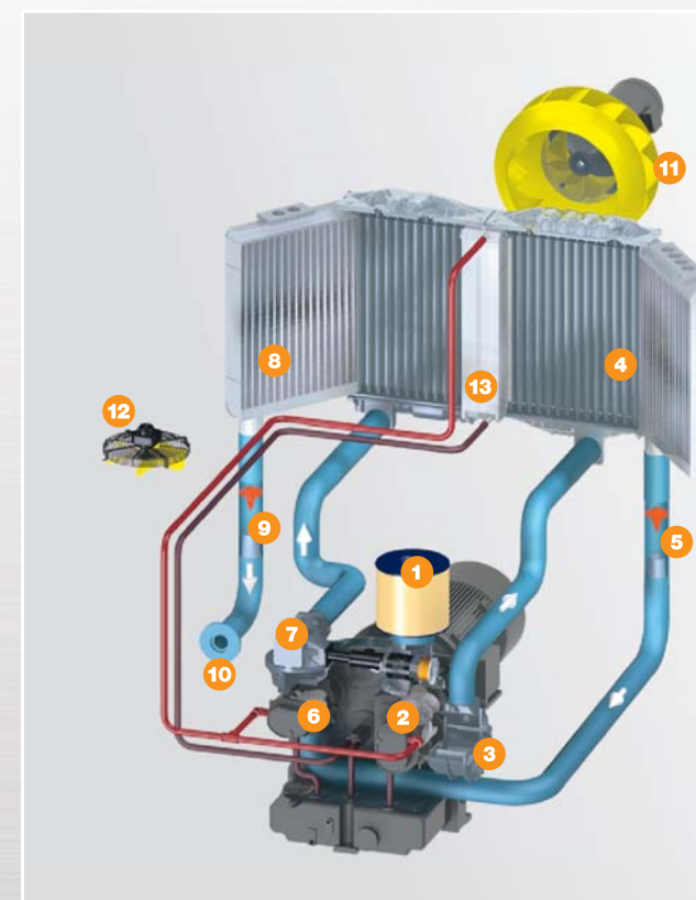
Рис.: Серийное исполнение DSG-2 (воздушное охлаждение)
